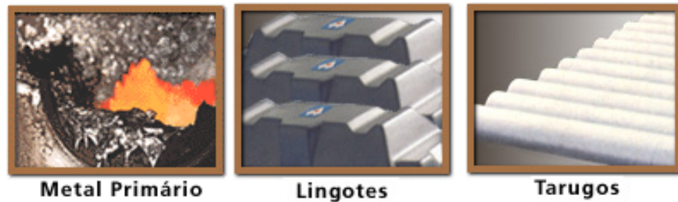
Figura 11. Metal primário, lingotes e tarugos
